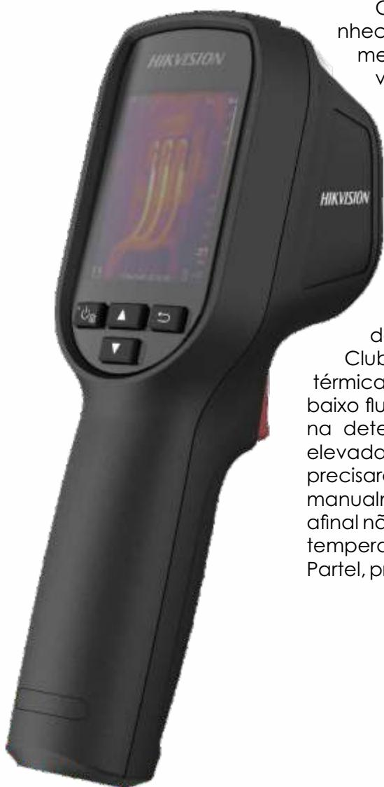
Câmeras térmicas detectam a temperatura reconhecendo e capturando diferentes níveis de luz infravermelha. Em cenários de pouca luz, com limitações visuais e até mesmo camuflagens, ela é muito eficiente, pois todos os objetos emitem um tipo de radiação infravermelha ou calor.
